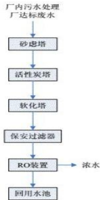
图 3.4-5 回用水系统流程图
